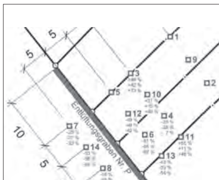
Abb. 3: Auswirkung Pilot-Entlüftungsgraben auf Methan-Konzentrationen in der Porenluft
